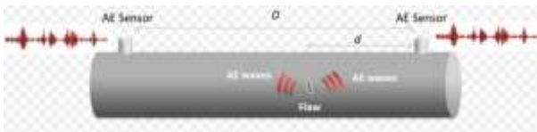
Figura 1. Esquema del principio de propagación de emisiones acústicas (EA).
